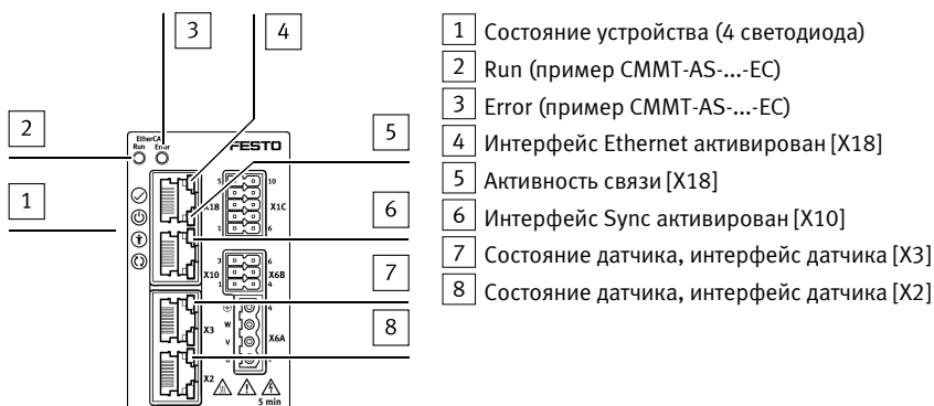
Fig. 27 Светодиоды на передней стороне (пример CMMT-AS-...-EC)
