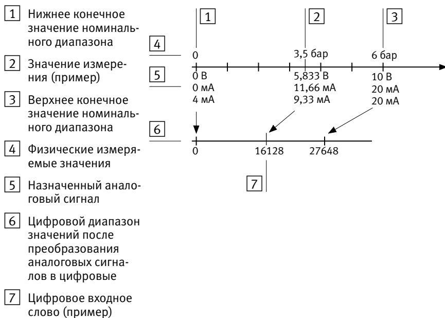
Рис. 3/3: Пример формата данных “VZ + 15 битов” для датчика давления с 0 ... 6 бар и диапазонов сигналов 0 ... 10 В, 0 ... 20 мА и 4 ... 20 мА
