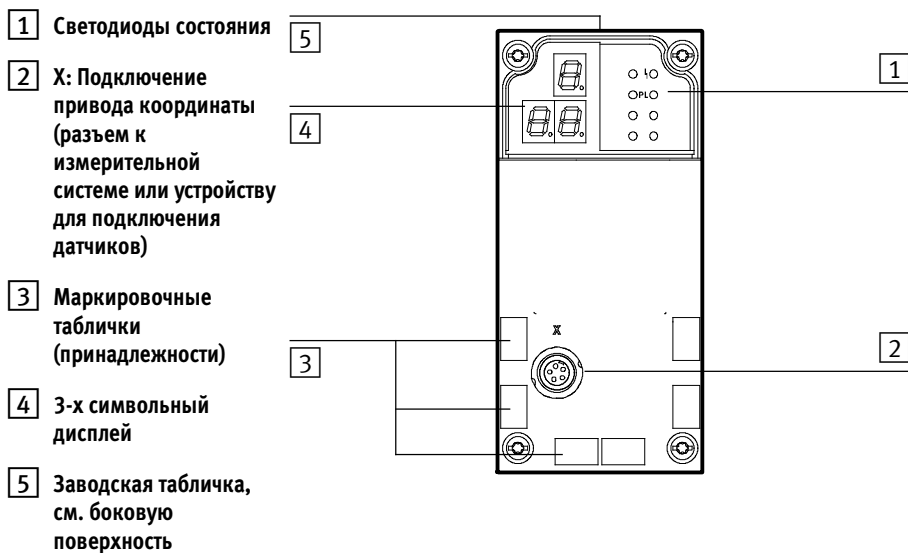
Рис. 1/1: Разъемы и средства индикации CMIX
