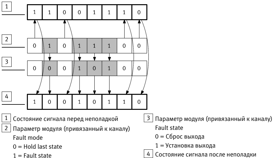
Fig. 12 Параметризация Fail safe – пример для двоичных сигналов
