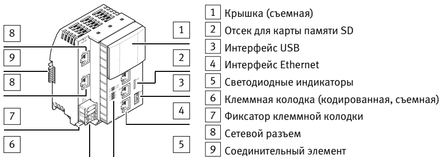
Fig. 3 Конструкция устройства управления (на примере CPX-E-CEC-C1-PN)
