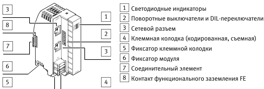
Fig. 2 Конструкция шинного модуля (на примере CPX-E-EC)
