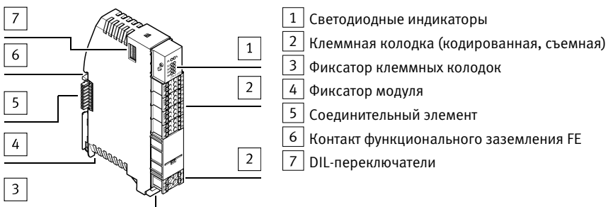
Fig. 4 Конструкция модуля входов/выходов (на примере мастер-модуля CPX-E-4IOL)
