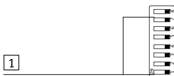
Рис. 1/4: Настройка номера станции (8-элементный DIL-переключатель 3)
