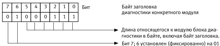
Рис. 3/4: Байт заголовка диагностики конкретного модуля
