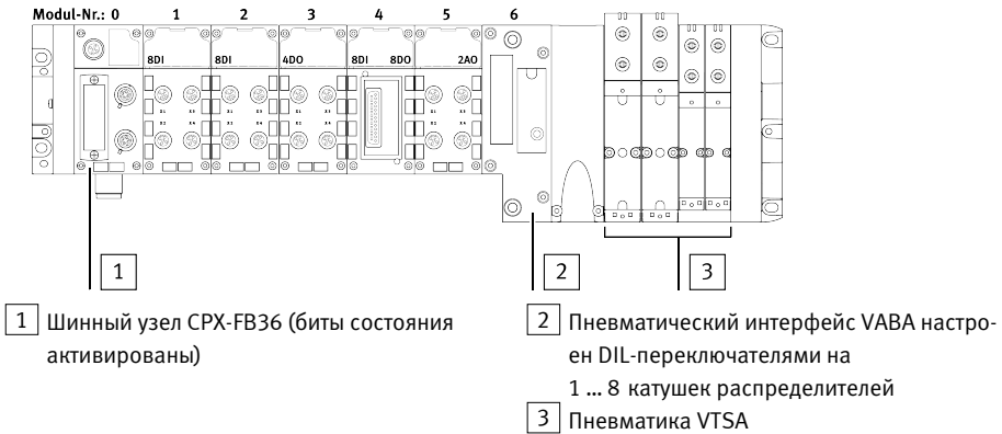
Fig. 25 Пример 3 – CPX-терминал с аналоговым модулем и VTSA-пневматикой
