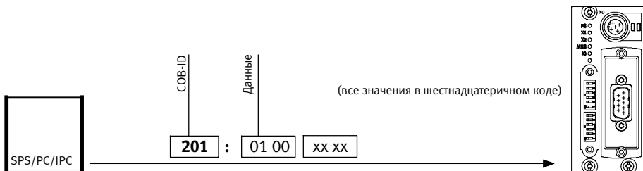
Рис. 1/4: Пример 2, установка выхода 0 шинного узла
