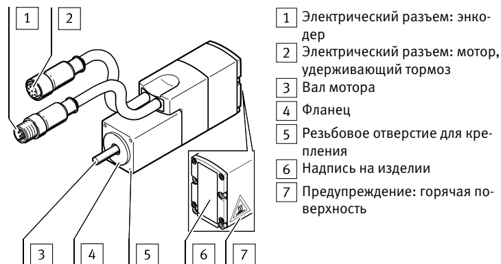
Fig. 1 Конструкция изделия EMMS-ST-28 (на примере EMMS-ST-28-...EB)
