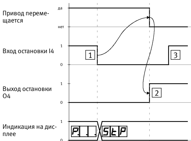
Рис. 4/3: Диаграмма последовательности действий при остановке
