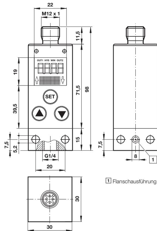
1 Flanschausführung, O-Ring Ø5 x 1,5 (NBR 70)
