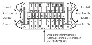
Die oben dargestellten Inseln mit 3 und 4 Drücken werden realisiert, indem extern vorgesteuerte 2 x 3/2-Ventile verwendet werden und der Anschluss umgekehrt über die Anschlüsse 3 und 5 erfolgt. Werden 2 x 3/2-Ventile umgekehrt angeschlossen, wirkt sich dies auch entsprechend auf die Funktionen aus, d. h., NC wird zu NO. NO zu NC.
