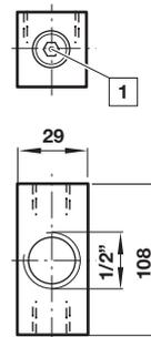
1 Mit zwei alternativen, verschlossenen G1/4 Anschlüsse
