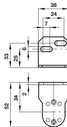
Sie benötigen 1/8" (3 mm) Schrauben um den Befestigungswinkel an der Wand zu montieren.
