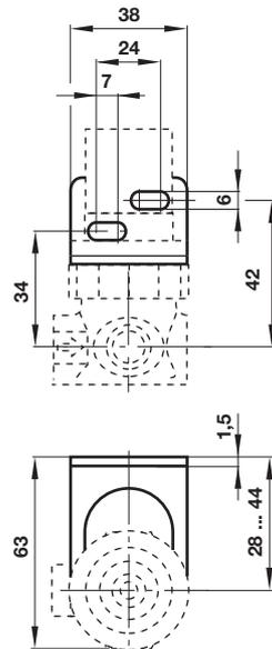
1 ø 31 mm für Panel-Bohrung
