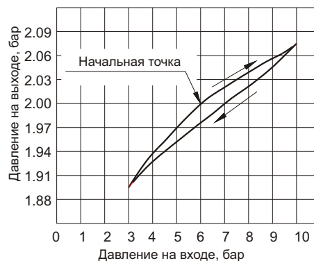
Расходные характеристики на сбросе (для 17112B.C)
