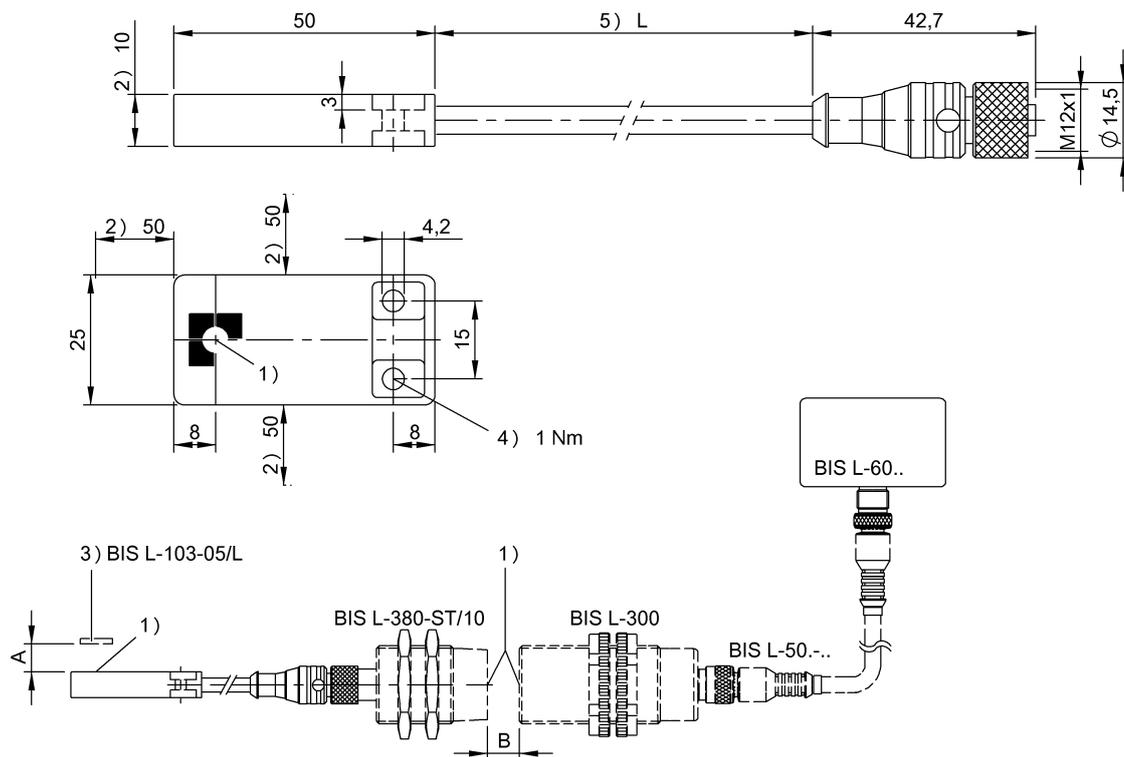
1) Активная поверхность, 2) Свободная зона, 3) Носитель данных, 4) Момент затяжки, 5) Длину кабеля см. в тексте
