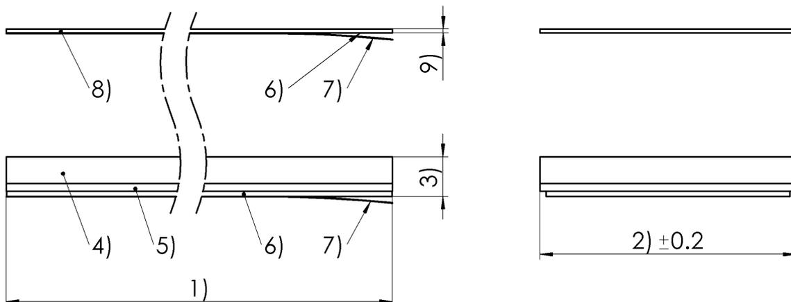
1) Номинальная / заказная длина, 2) Ширина, 3) Высота измерительного элемента, 4) Магнитный слой, 5) Несущая лента, 6) Клеевой слой, 7) Защитная пленка, снимается, 8) Защитная лента, 9) Высота защитной ленты
