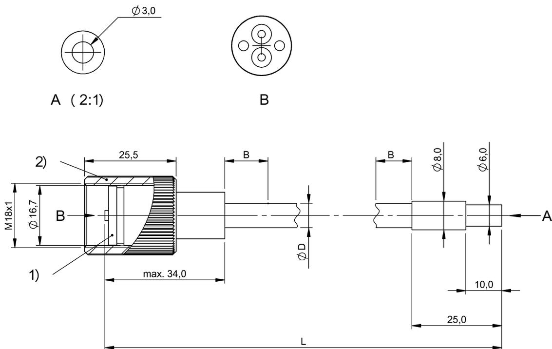
1) Съемная шайба, 2) Накидная гайка
