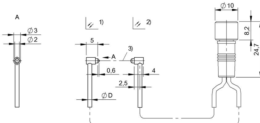
1) Передатчик, 2) Приемник, 3) Оптическая ось
