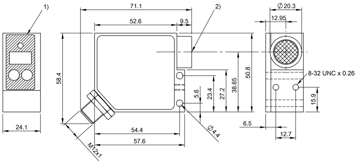
1) Панель индикации и управления, 2) Оптическая ось
