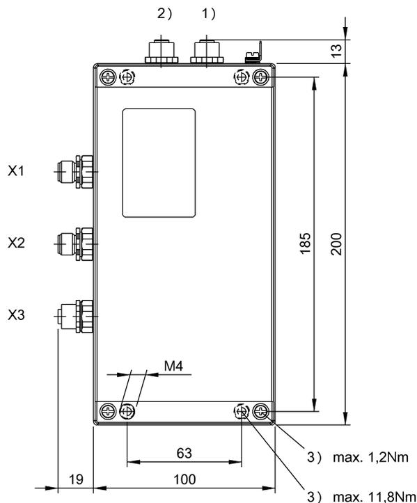
1) Головка 1, 2) Головка 2, 3) Момент затяжки
