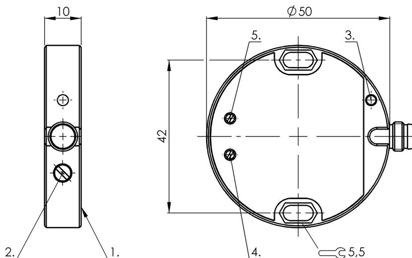
1) Активная поверхность, 2) Потенциометр, 3) Функциональный СД, 4) По выбору замыкатель или размыкатель, 5) PNP или NPN на выбор
