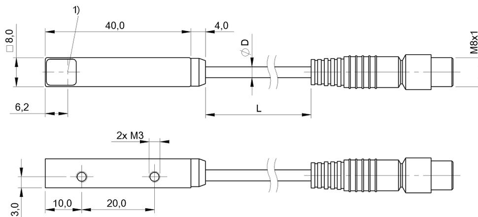
1) Оптическая ось, передатчик
