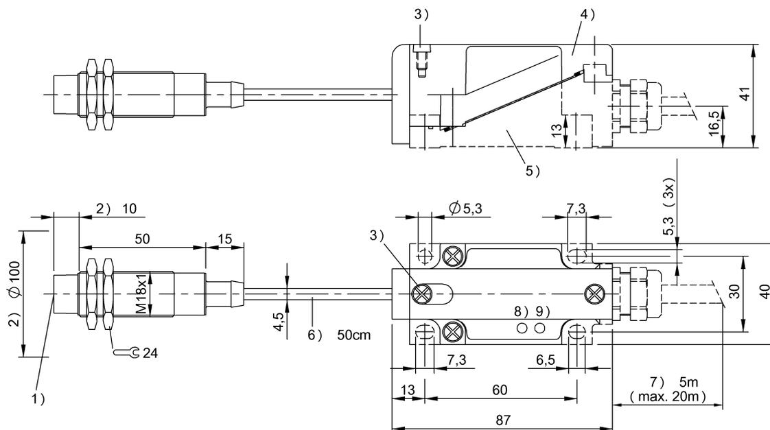
1) Активная поверхность, 2) Свободная зона, 3) Стопорный винт, 4) Модульный блок, 5) Монтажный цоколь, 6) Длина кабеля, 7) Стандартная длина, 8) Питание, 9) Присутствует тэг
