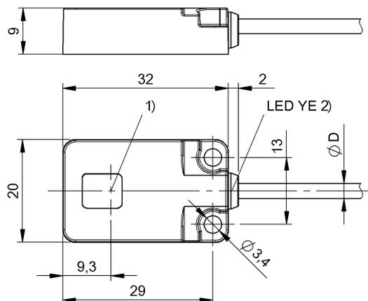
1) Оптическая ось, приемник, 2) Функция выхода
