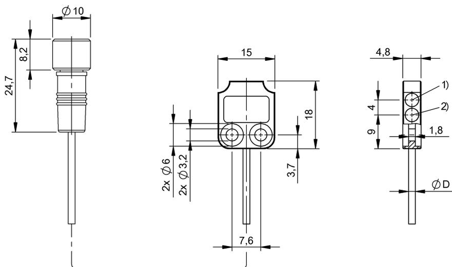
1) Оптическая ось, передатчик, 2) Оптическая ось, приемник
