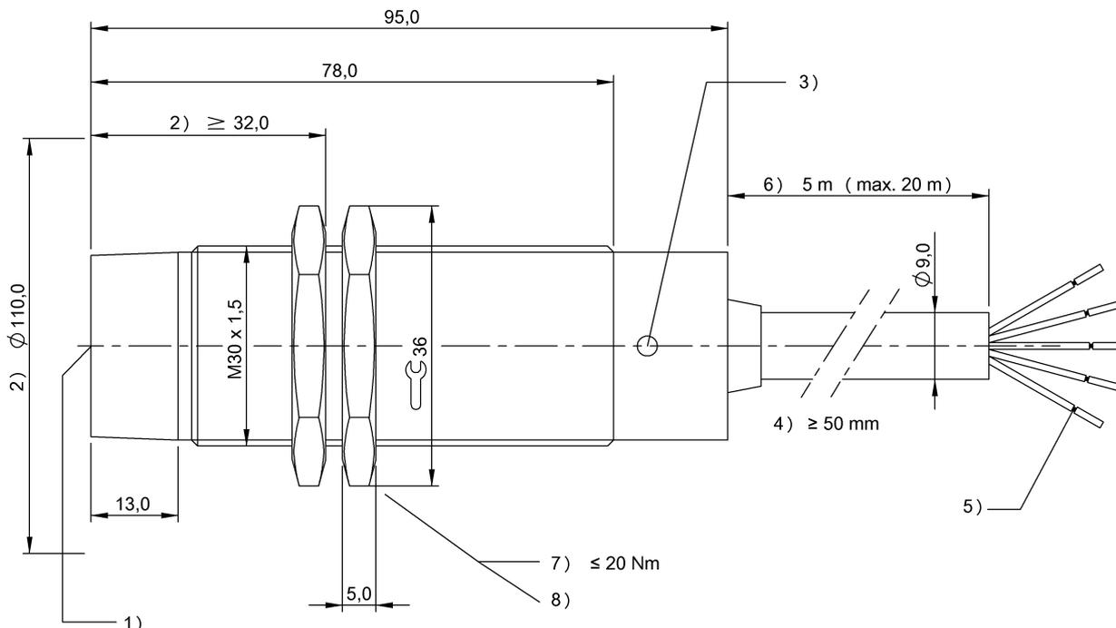
1) Активная поверхность, 2) Свободная зона, 3) данные действительны, 4) Радиус изгиба кабеля, 5) Снятие изоляции, 6) Стандартная длина, 7) Момент затяжки, 8) См. примечания
