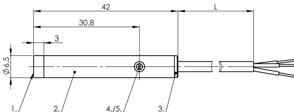
1) Активная поверхность, 2) Корпус, 3) Крышка, 4) Потенциометр, 5) Функциональный СД
