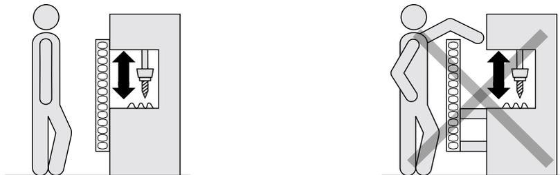
Рисунок 8: Пример возможности проникновения над зоной обнаружения электрочувствительного защитного устройства. Слева: защитное поле, исключающее проникновение над зоной обнаружения. Справа: защитное поле, допускающее возможность проникновения над зоной обнаружения.
