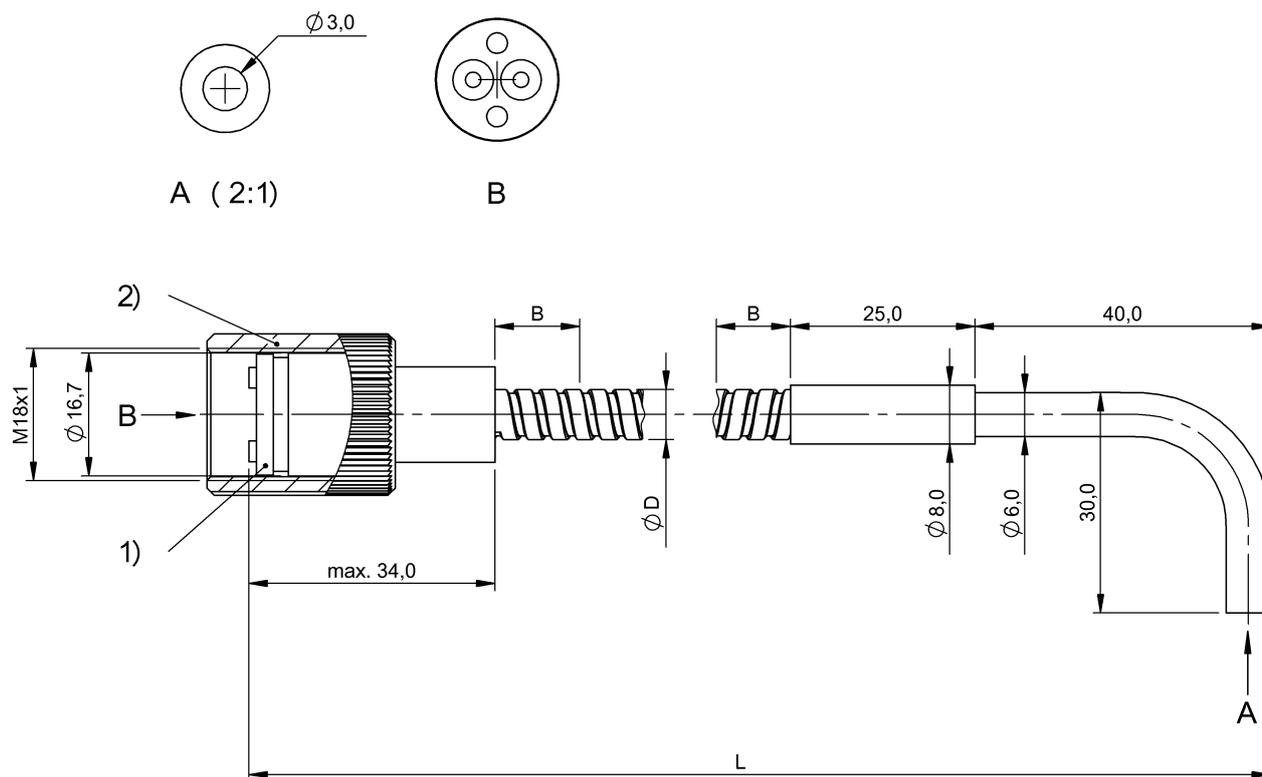
1) Съемная шайба, 2) Накидная гайка
