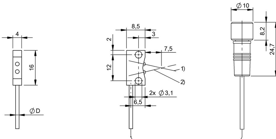
1) Оптическая ось, передатчик, 2) Оптическая ось, приемник
