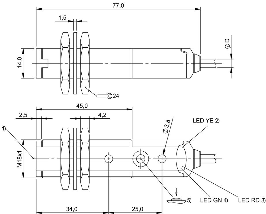
1) Оптическая ось, 2) Функция выхода, 3) Стабильность / сбой, 4) Sn
