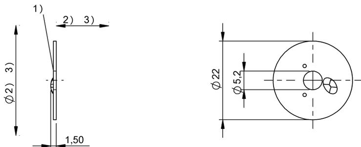
1) Активная поверхность, 2) Свободная зона, 3) см. соответственно головку записи/считывания, 4) Момент затяжки
