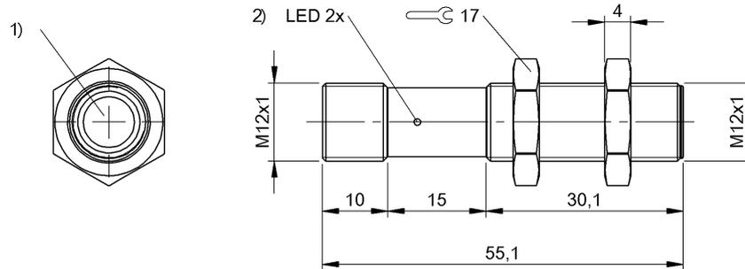
1) Ось ультразвукового преобразователя, 2) Направление отхода 90° штекер, 3) Напряжение питания, 4) Функция выхода
