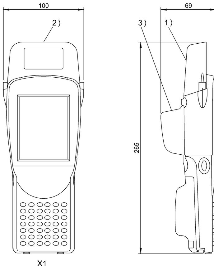
1) Активная поверхность, 2) Форму антенны см. в данных, 3) Одномерный сканер штрих-кодов
