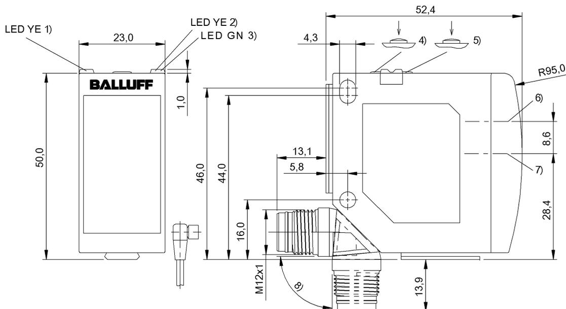
1) Функция выхода Q1, 2) Функция выхода Q2, 3) Напряжение питания, 4) Регулировка Q1, 5) Регулировка Q2, 6) Оптическая ось, передатчик, 7) Оптическая ось, приемник, 8) Поворачивается на 270°
