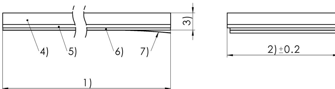
1) Номинальная / заказная длина, 2) Ширина, 3) Высота измерительного элемента, 4) Магнитный слой, 5) Несущая лента, 6) Клеевой слой, 7) Защитная пленка, снимается
