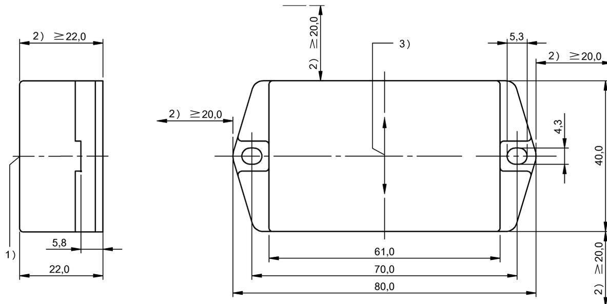
1) Активная поверхность, 2) Свободная зона, 3) Ось записи / считывания
