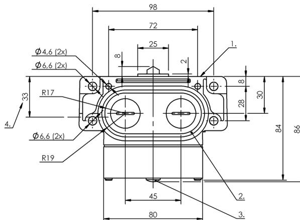
1) Опорная кромка, 2) Уплотнительное кольцо, 3) Функциональный индикатор FD/FE/LL, 4) Кабельный ввод, 5) Марк. Безопасн. точка переключения
