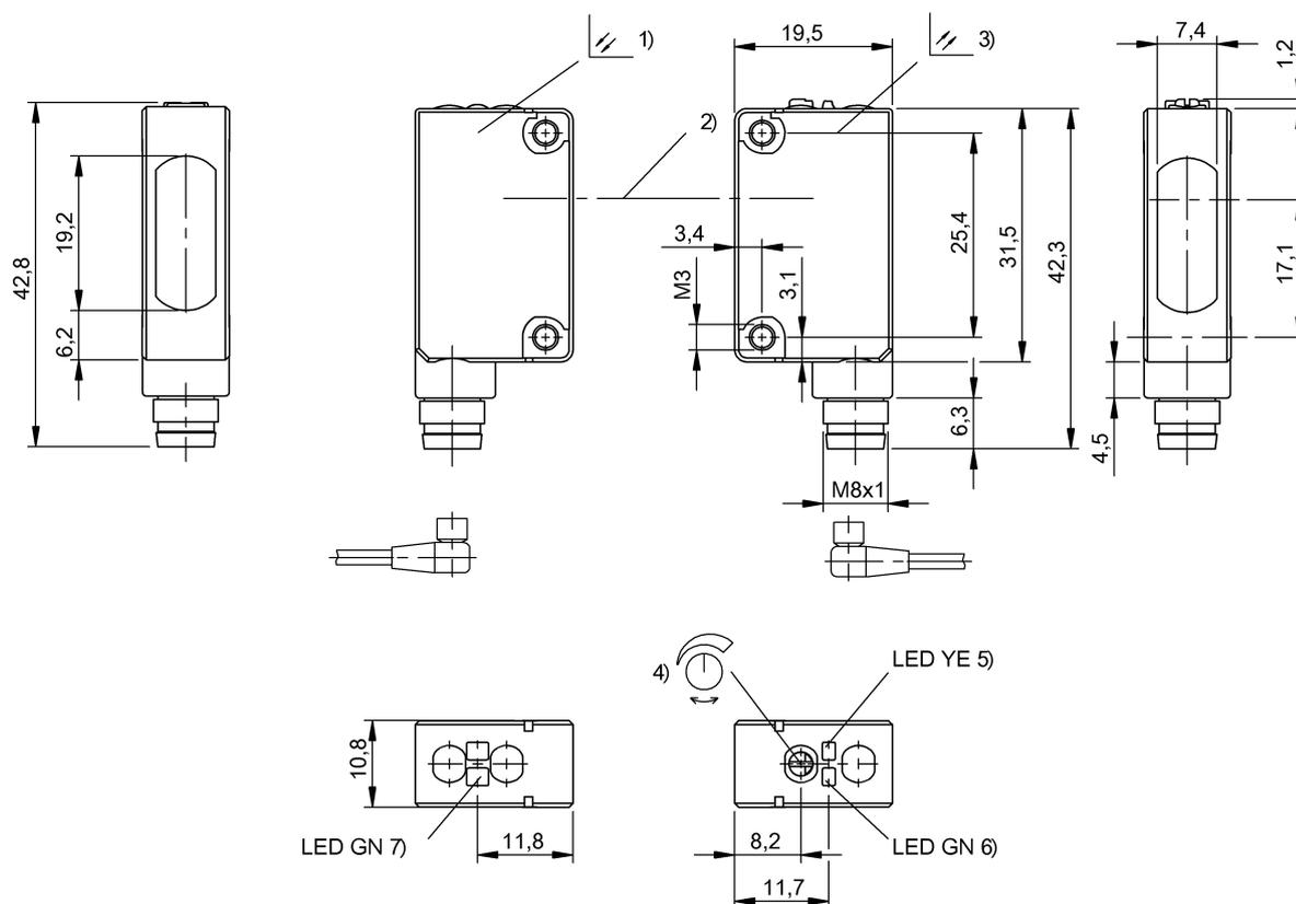
1) Передатчик, 2) Оптическая ось, 3) Приемник, 4) Чувствительность, 5) Функция выхода, 6) Стабильность, 7) Напряжение питания
