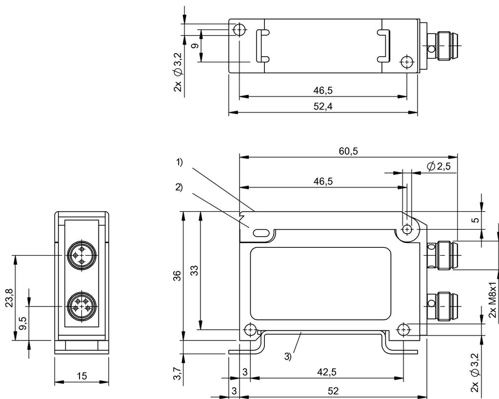
1) Панель индикации и управления, 2) Крышка, 3) Защитная шина
