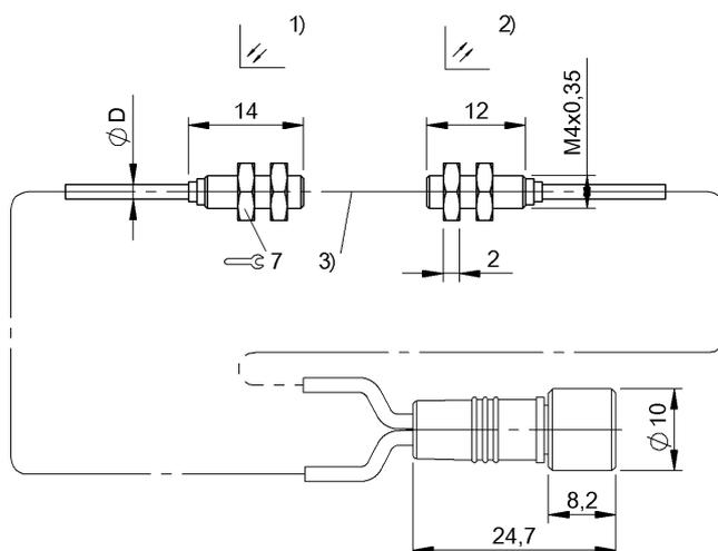
1) Передатчик, 2) Приемник, 3) Оптическая ось
