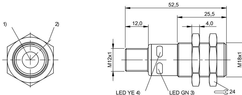
1) Ось ультразвукового преобразователя, 2) Направление отхода 90° штекер, 3) Напряжение питания, 4) Функция выхода
