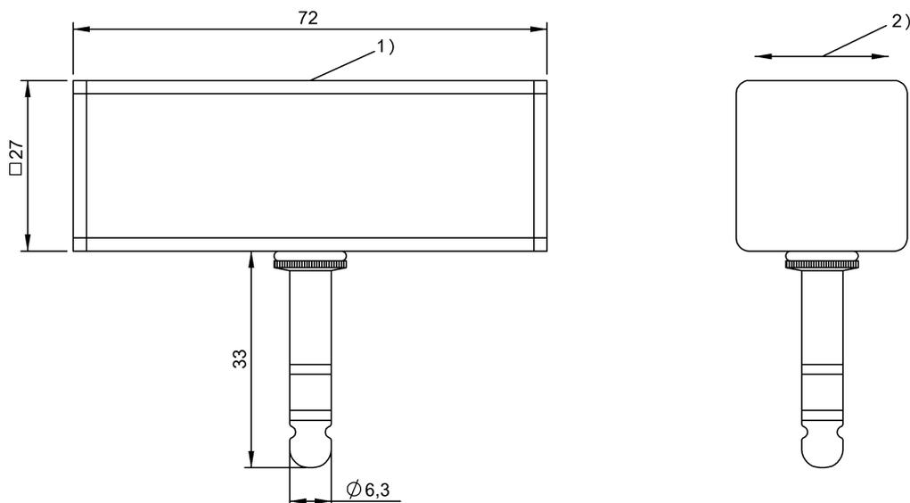
1) Активная поверхность, 2) Ось записи / считывания
