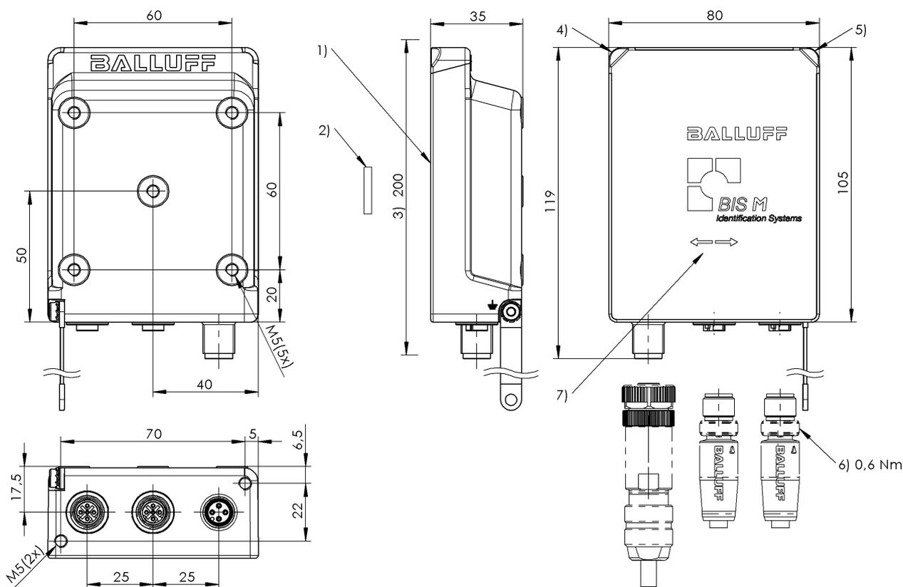
1) Активная поверхность, 2) Носитель данных, 3) Свободная зона, 4) СД (питание), 5) СД (CP), 6) Момент затяжки, 7) Ось записи / считывания
