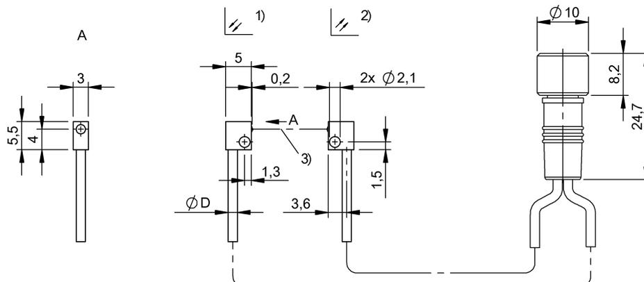
1) Передатчик, 2) Приемник, 3) Оптическая ось
